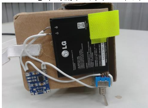
圖十八 電源部分與電源開關
