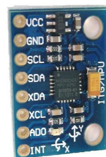
圖四 MEMS 三軸陀螺儀電容極板構造與 Y 軸電容極板 圖五 MPU-6050 陀螺儀
